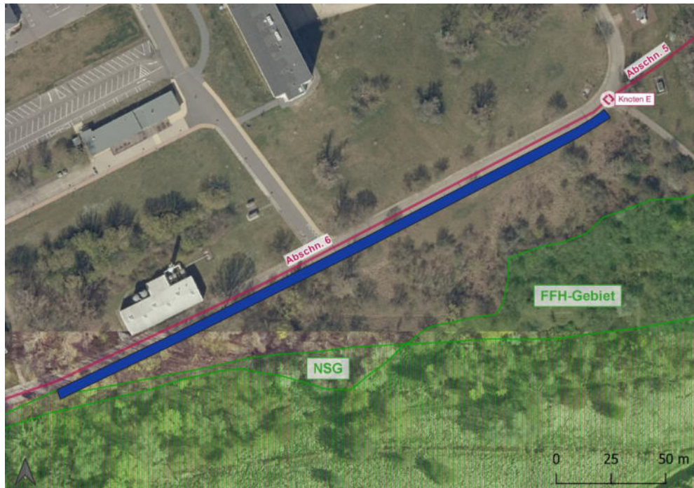
Abb. 7: Skizze Platzbedarf für 100 Parkstände in Schrägaufstellung entlang der Rudolf-Bahro-Straße
